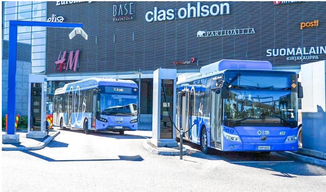
Kuva 6. Vasemmalla ylhäällä ajoneuvo saapumassa virroitinlataukseen (pantografii) ja oikealla perinteinen kaapelilataus. [35]
