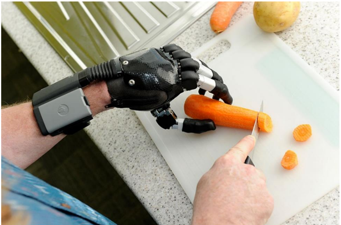
Kuva 1. Kuvassa on esitetty eräänlainen sähkötoiminen käsiproteesi ('The Complete Guide To Arm & Hand Amputations and Prosthetics | MCOP' n.d.)
