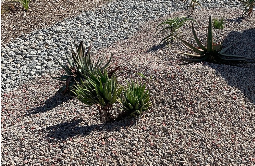
Kuva 4. EEJ-asetuksen myötä betonimursketta voidaan hyödyntää myös kasvualustana. (Moreton Bay Recycling 2019)
