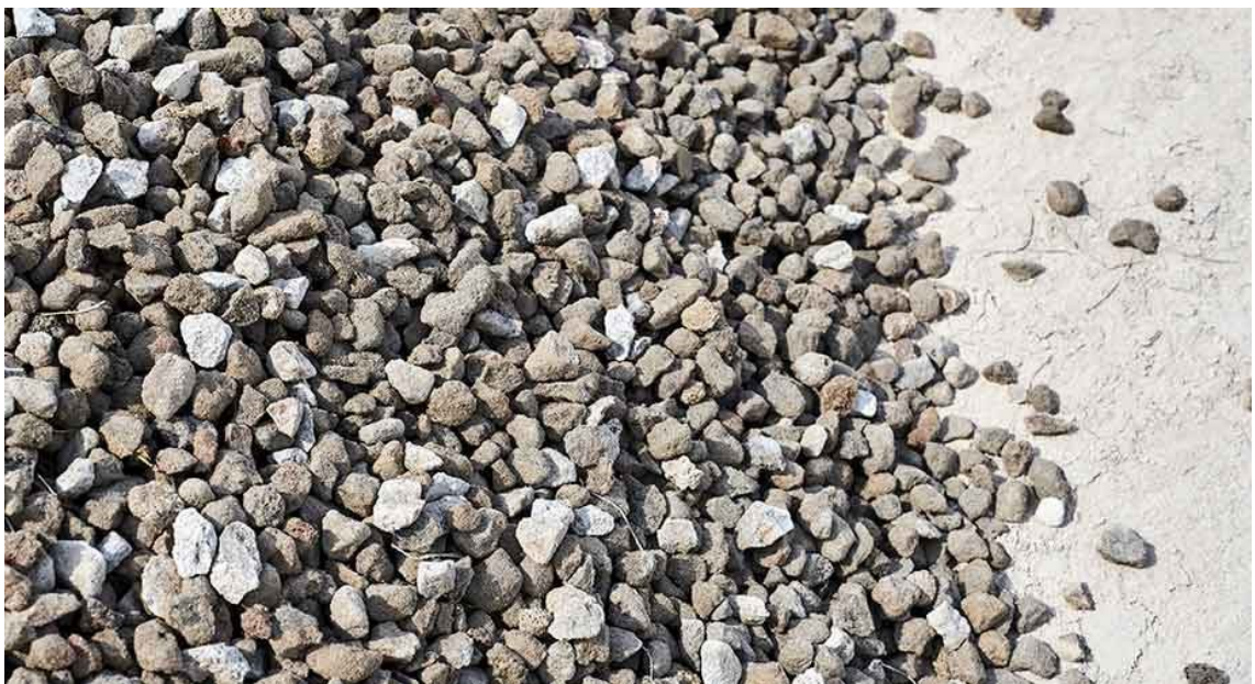
Kuva 1. Puhdistettua ja seulottua betonimursketta. (Rudus 2022)
