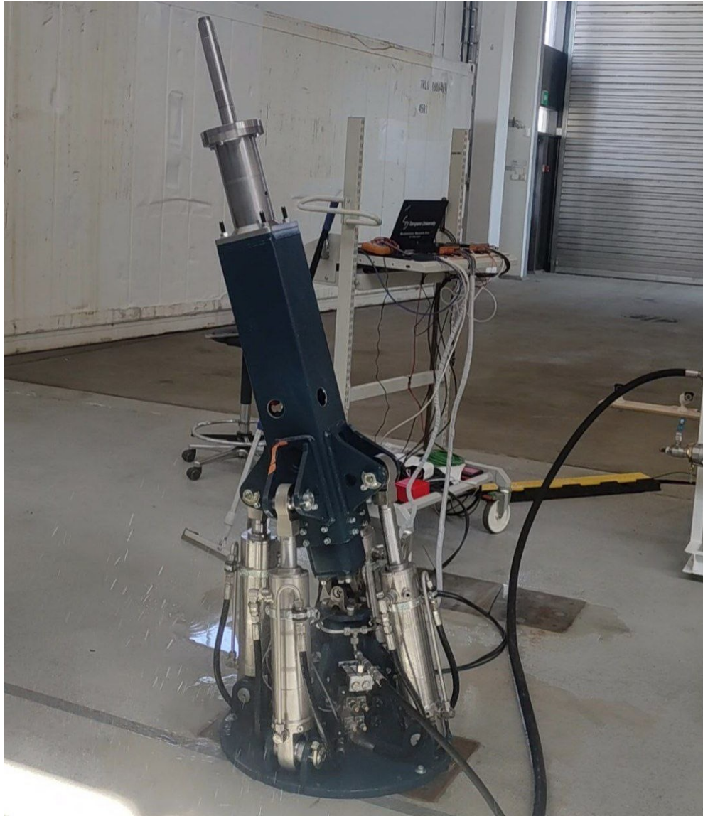
Kuva 27. Tapaustutkimuksessa suunniteltu puomi kokoonpantuna testipenkkiin.
