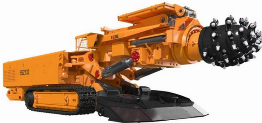
Kuva 8. Kuvassa on pienikokoinen roadheader-tyyppinen louhija NGH:n EBZ132C, jonka massa on 36 tonnia. (nhgtunnel.com)
