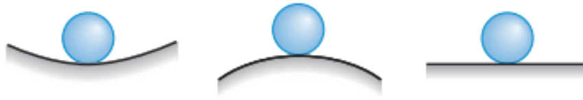
Kuva 2. Pallo stabiilissa, labiilissa ja indifferentissä tasapainossa (Gere & Goodno 2012, s. 527).
