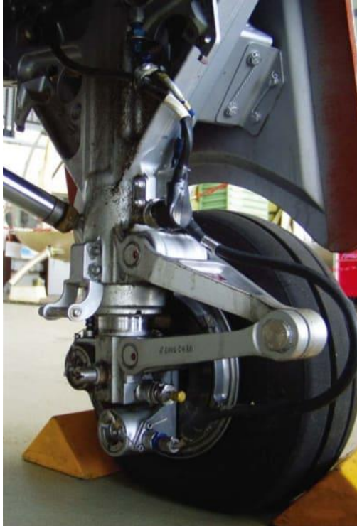
Kuva 1. Kromipinnoitus lentokoneen laskeutumistelineen rungossa [17].
