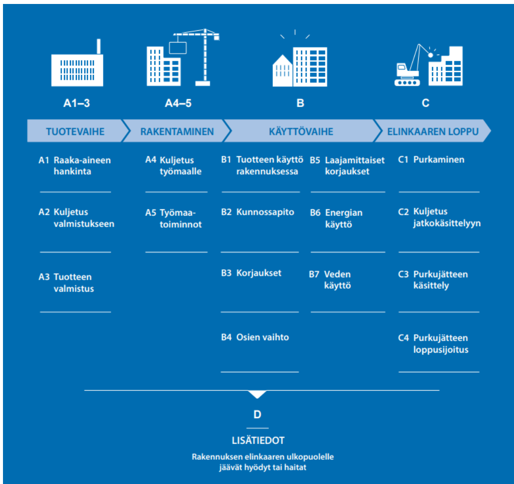
Kuva 1: Rakennuksen elinkaaren vaiheet (Kuittinen 2019,14)
