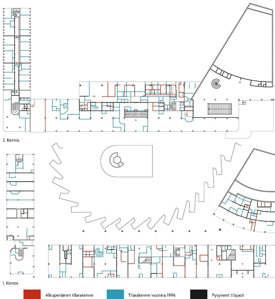
Kuva 6 Vertailu alkuperäisen vuoden 1935 tilarakenteen ja vuoden 1996 tilajaon välillä ensimmäisessä ja toisessa kerroksessa. (Sirola, 2023)
