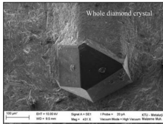
Kuva 11 Kokonainen timanttikide kiinnittyneenä matriisiin [18]
