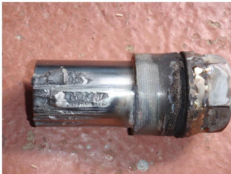
Kuva 3 Kaplan-turpiinin säätölenkin ristikappaleeseen kiinnittävä tappi on tahmautumisen takia kokenut vaurioita irrotuksen aikana.
