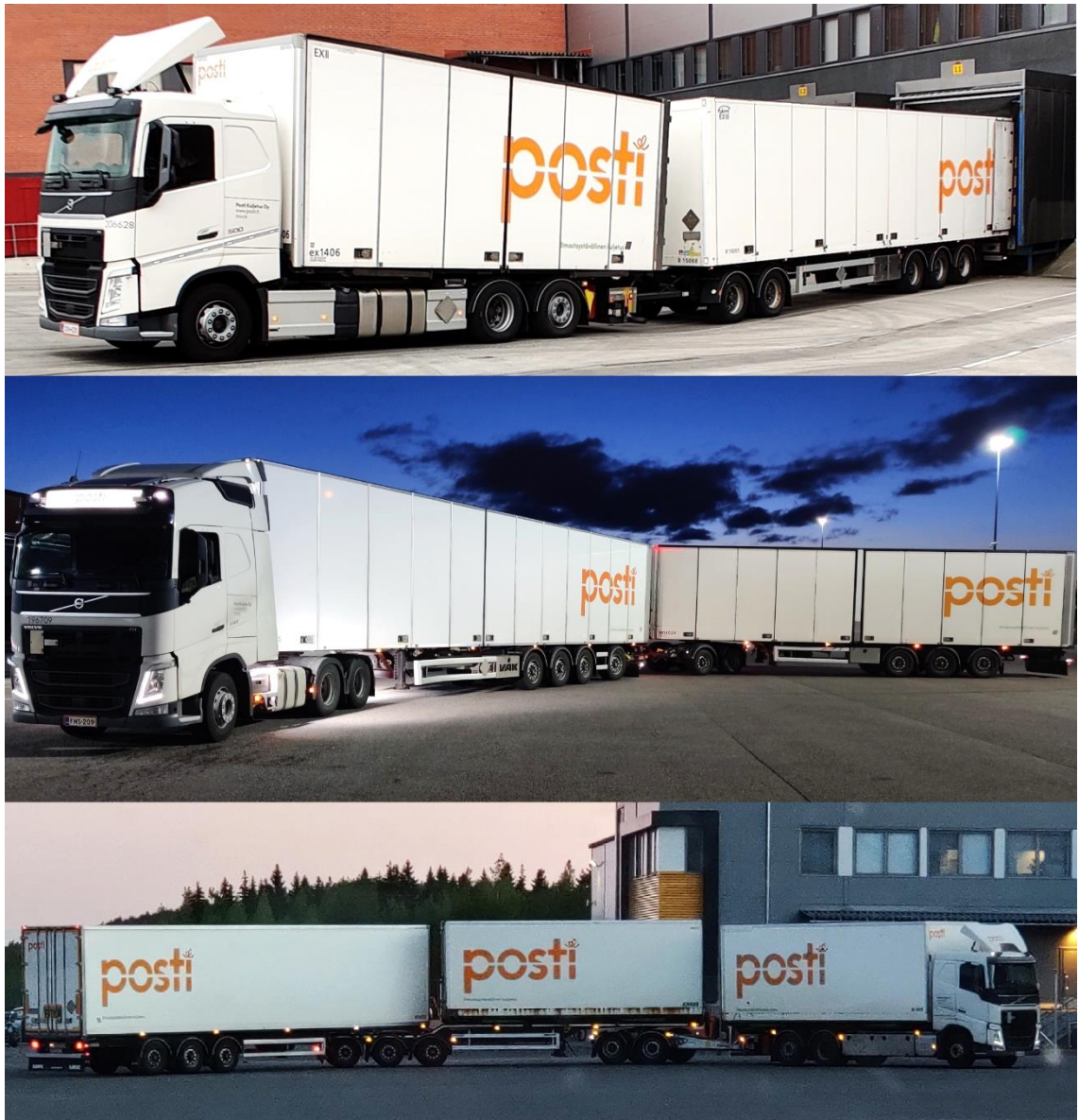
Kuva 1. Ylin: Täysperävaunuyhdistelmä (konttiauto + TPV). Keskellä: A-tupla HCT-yhdistelmä (rekka veturi + PPV + dolly + PPV). Alin: AB-tupla HCT-yhdistelmä (konttiauto + dolly + linkkivaunu (+kontti) + PPV).
