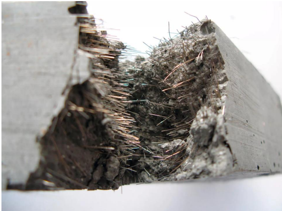
Kuva 11. Teräskuiduilla vahvistettu kuitubetoni [43]
