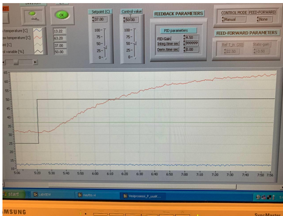
Kuva 13. Lämmitysprosessin askelvaste, kun ohjaus muutettiin 25 %:sta 50 %:iin.
