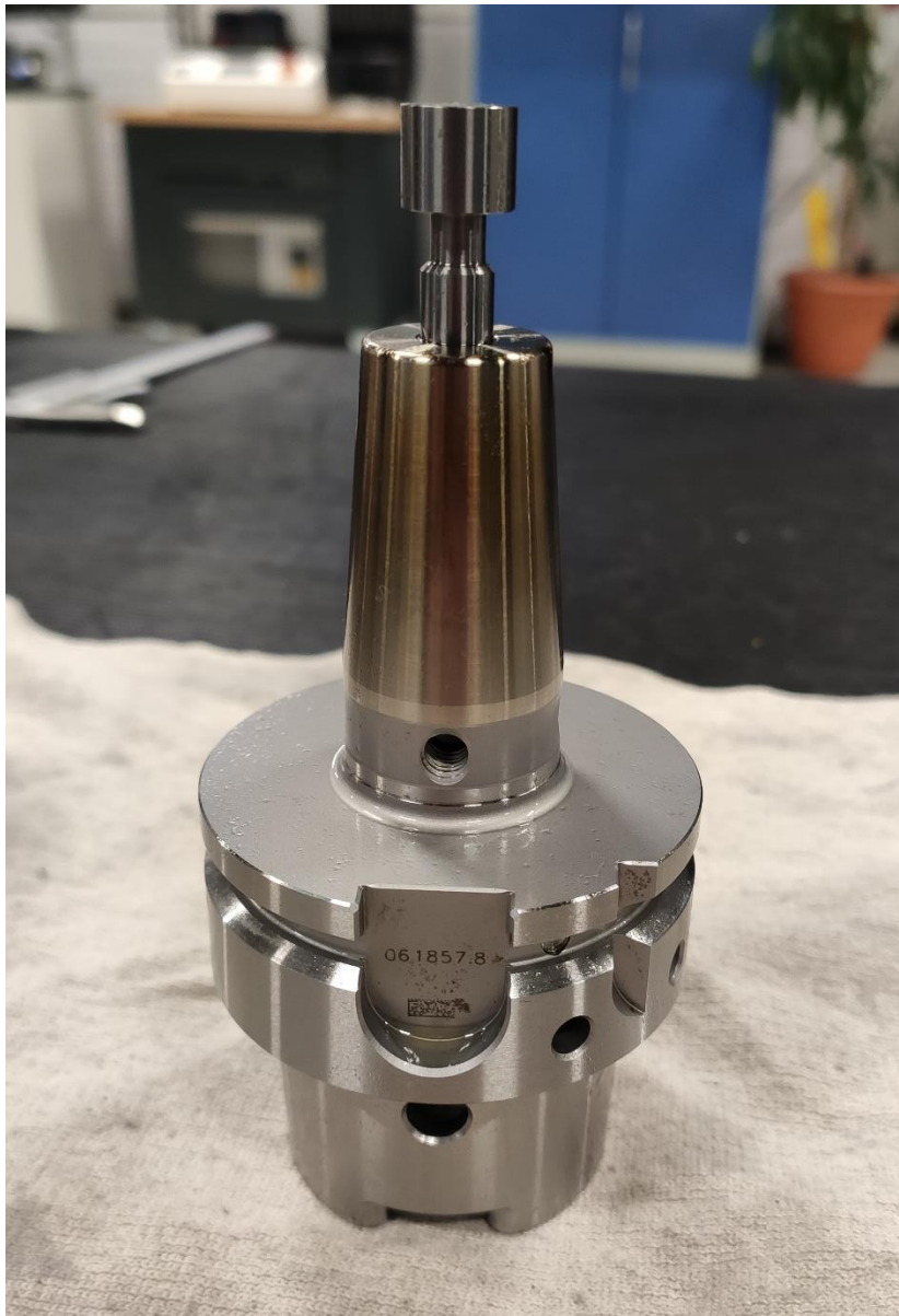
Kuva 4: Työkalun koneen sisäisen mittauksen kalibroinnissa käytettävä mittaesine
