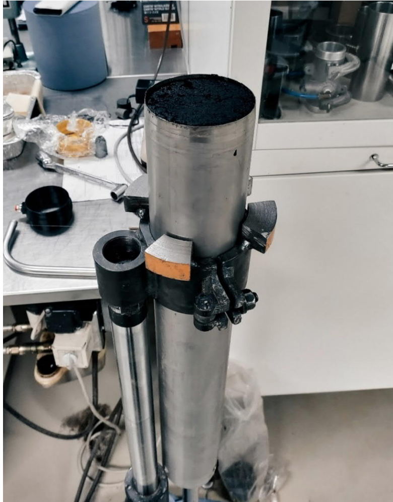
Kuva 58. 86 mm näyteputki näytteen ulostyöntäjässä
