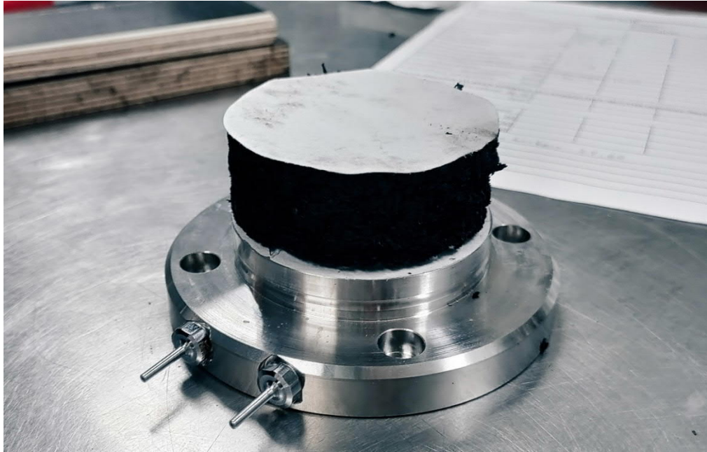
Kuva 62. Valmis DSS-koekappale jalustalla
