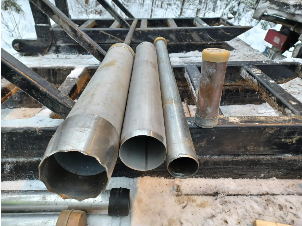
Kuva 57. 100 mm avoin näytteenotin, Aalto-yliopiston 86 mm näyteputki, ST1-näytteenotin ja ST-1 näytteenottimen näytepurkki
