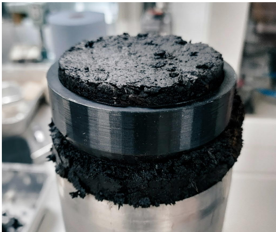
Kuva 61. 70 mm DSS-koekappaleen leikkaamista
