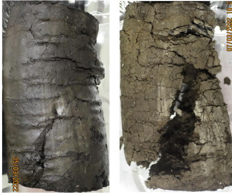
Kuva 71. Ratapenkereen alta otettu leikattu näyte märkänä (vasemmalla) ja kuivana (oikealla)
