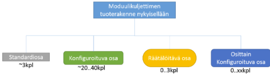
Kuva 24. Modulaarisen ketjukuljettimen tuoterakenne. (Mäki, 2018)
