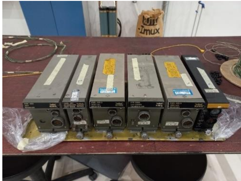
Kuva 9. Vanha hylly ja sillä olleet laitteet. Laitteiden painot vasemmalta oikealle 3840 g, 1530 g, 3200 g, 3462 g, 3215 g ja 2095 g.
