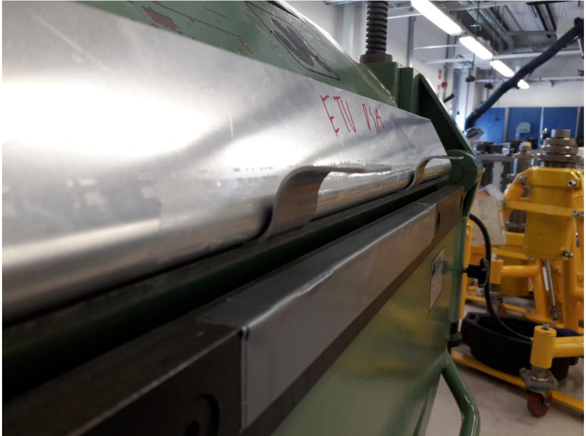
Kuva 26. Osan taivutus loppuun särmäyskoneella
