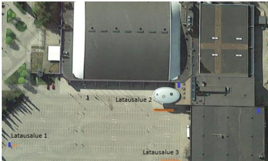
Kuva 15: Havainnekuva Lahden Urheilu- ja Messukeskuksen latausjärjestelmästä. Latausalueet merkittynä oranssilla ja uudet latauskeskukset sinisellä. Latausalueen 3 latauskeskus on tontin kiinteistön sähköpääkeskuksesta kuvan oikeassa reunassa. [64]
