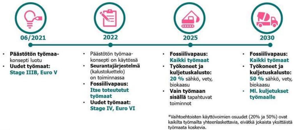
Kuva 3 eteneminen kohti päästötöntä työmaata (Varis ja Rovio 2021)
