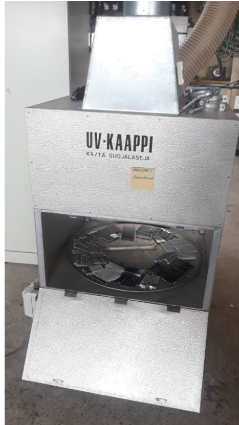
Kuva 18. Työssä käytetty ultraviolettikaappi, jossa ultraviolettisäteily tuotetaan kirkkailla lampuilla. Metallinen näytealusta pyörittää näytteitä tasaisella nopeudella lampujen valossa. Kuva on otettu ja julkaistu Elastopolin luvalla.
