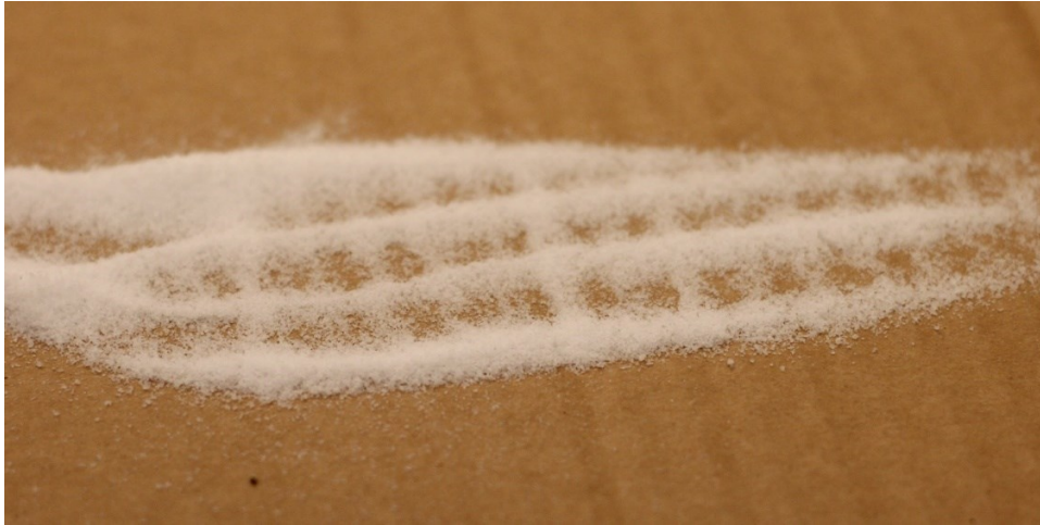
Kuva 3. Kuvassa on rotaatiovaluun käytettyä neitseellistä polyeteenijauhetta, jonka keskimääräinen raekoko on 0,3 mm.
