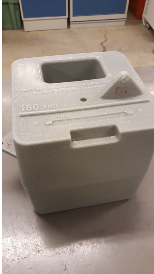
Kuva 16. Polymeerihallilla valmistettu rotaatiovalukappale, jossa on 10 m% kierrätysmuovia ja 90 m% muovi 1.
