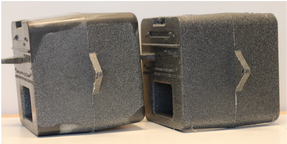
Kuva 1. Pyörimisnopeuden ja pyörimissuunnan vaihtamisella on suuri vaikutus lopputuotteen laatuun. Kierrätysmuovia käytettäessä työstön merkitys korostuu. Kuvassa vasemmalla on rotaatiovalettu tuote, jonka pyörimissuuntaa ei ole muutettu työstön aikana. Oikealla tuote, jonka pyörimissuuntaa on muutettu useaan kertaan.
