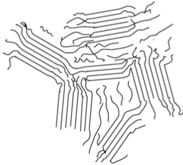
Kuva 7. Kuvassa on esitetty amorfiset (ei järjestäytyneet) ja osakiteiset (järjestäytyneet) alueet polymeerin rakenteessa. [10, s.20]
