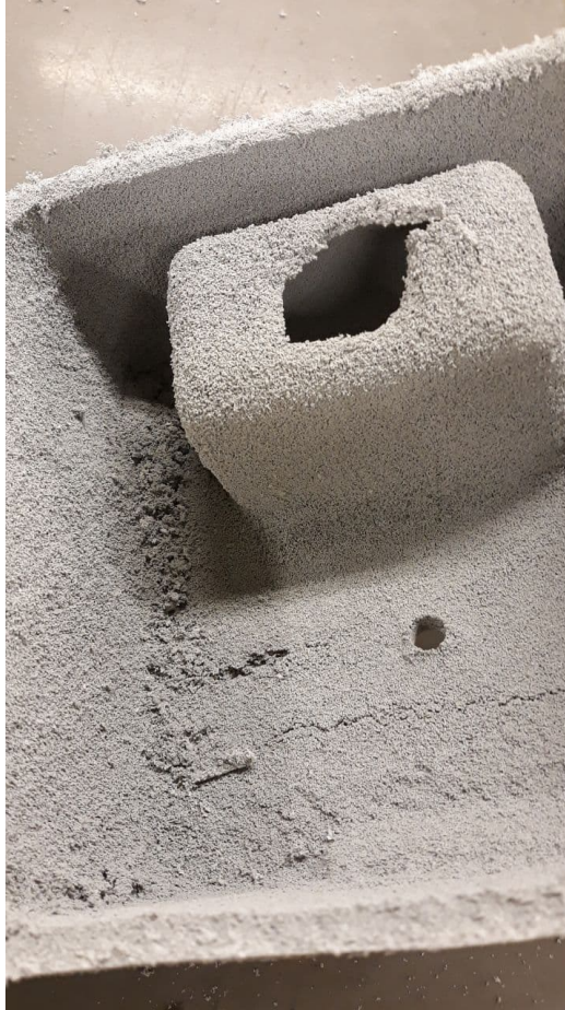
Kuva 15. Kierrätyspolyeteeni ei vielä sovellu käytettäväksi sellaisenaan rotaatiovalu- tuotteen valmistamiseen.
