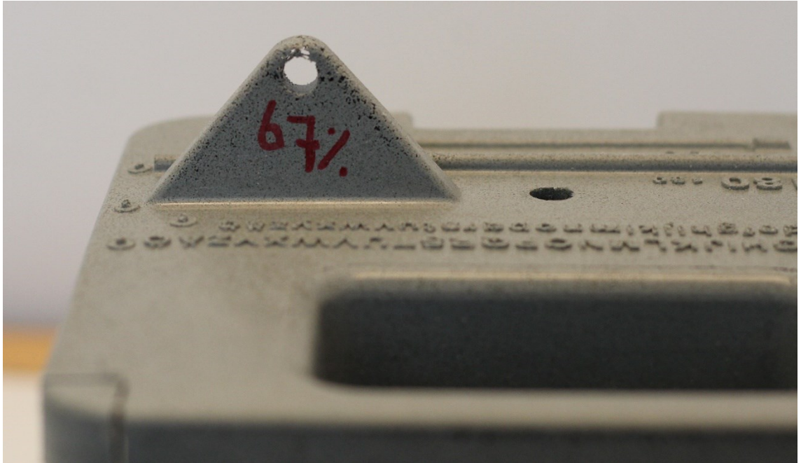
Kuva 40. Kuvassa on polymeerihallilla valmistetun kappaleen ”ripa”, joka on muotin vaikein muoto täyttää. Kappaletta tarkastellessa havaitaan, ettei polymeeri ole täyttänyt ripaa kokonaan, syynä on polymeerin riittämätön sulavirtaaminen.
