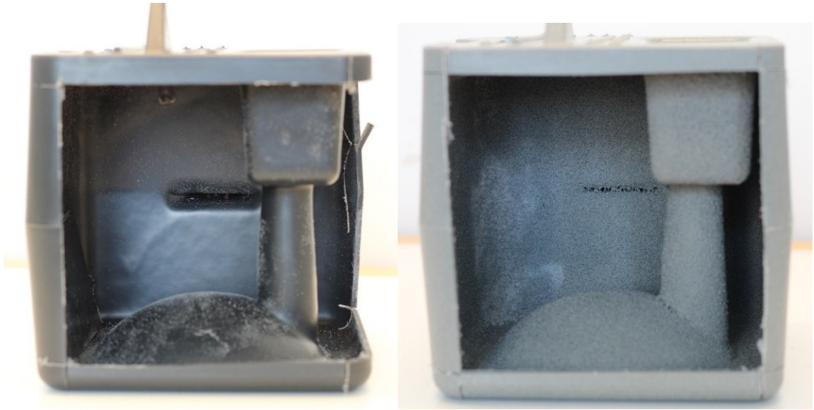
Kuva 32. Kuvassa vasemmalla on 100 m% tummanharmaaksi värjätystä muovi 1:stä valmistettu tuote ja oikealla seos 30 m% kierrätysmuovia ja 70 m% muovi 1 sisältävästä seoksesta valmistettu tuote.
