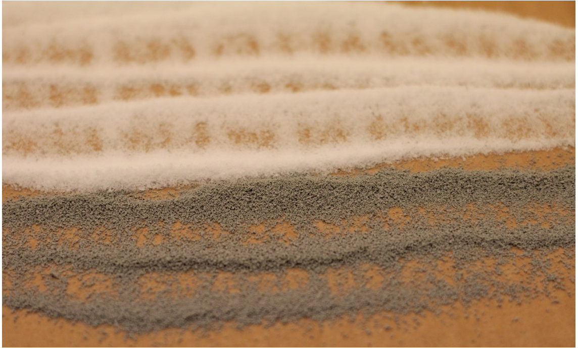
Kuva 14. Kuvan yläaidassa on neitseellistä polyeteeniä ja sen alapuolella kierrätettyä polyeteeniä. Raekoko molemmilla jauheilla on sama: 0,3 mm. Molemmat jauhot ovat värjäämättömiä ja värieron selittääkin ainoastaan kierrätettävän materiaalin koostumus useasta erivärisestä muovista.
