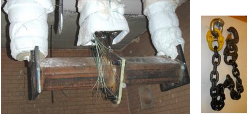
Kuvio 20. Kuormitusjärjestelyn yksityiskohtia: a) Kuormituskehän uunin yläpuolella oleva rakenne sekä kuormitusjärjestely, b) ketjun kiinnitys tunkkiin, c) koekappaleen ulokepään kiinnitetty nostolevy ketjun kiinnitystä varten sekä d) ja e) koekappaleen kiinnitys neliöputkeen K1.
