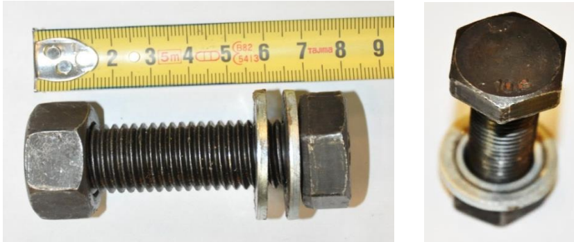
Kuvio 16. Jatkosliitoksessa käytetyt ruuvi, mutteri ja aluslaatat
