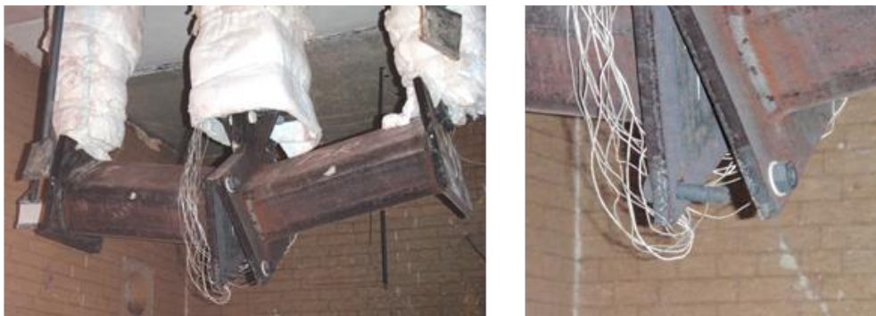
Kuvio 37. Koekappale TE3* luukusta katsottuna kokeen jälkeen
