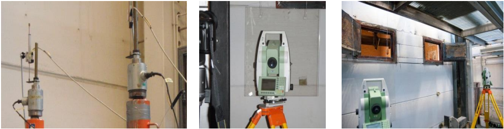
Kuvio 22. Siirtymämittauslaitteisto, johon kuului hydraulisten tunkkien pystysuuntaa mittaavat anturit sekä kaksi takymetriä
