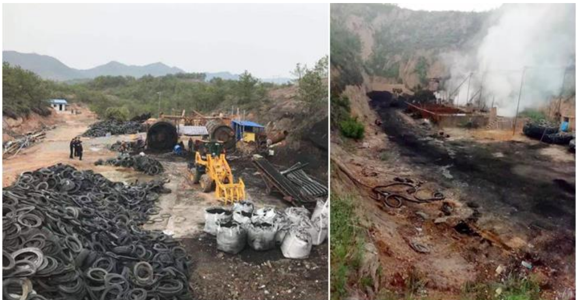
Kuva 1. Huonosti järjestelty jätepyrolyysilaitos aiheuttaa saastetta [25]
