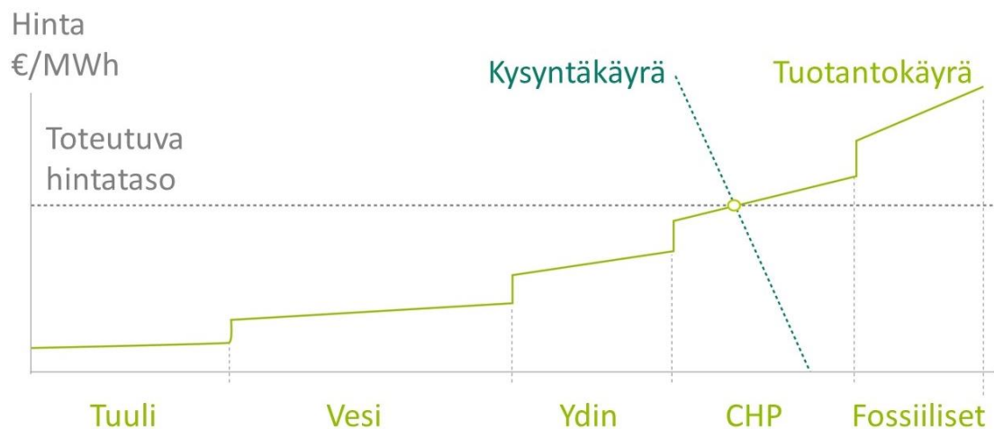
Kuva 5: Sähkön kysyntä, tarjonta, sekä tuotantokustannukset, muokattu lähteestä [30]
