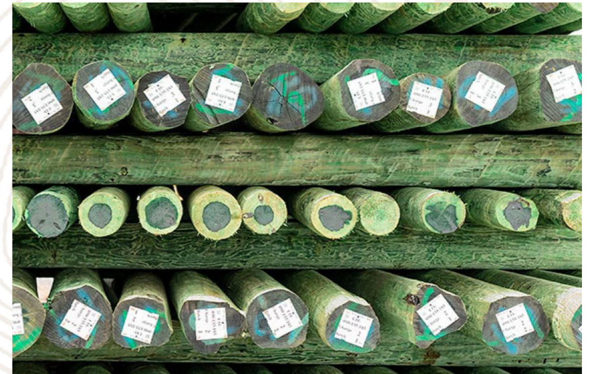
Kuva 28. Kupariöljyllä kyllästettyjä puupylväitä. (Scanpole 2020.)
