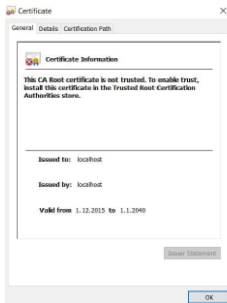
Kuva 4.2. Virheellisen sertifikaatin tarkastelu osoittaa, että luottamus sertifikaatin myöntäjään saadaan lisäämällä se käyttöjärjestelmän luotettujen tahojen varastoon.
