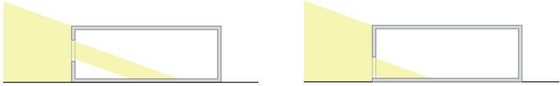
Kuva 8 Ikkunan vertikaalisen sijainnin vaikutus keskellä ja matalalla luonnonvalon syvyyteen huoneessa. Lähde: Vikberg 2014, 75.
