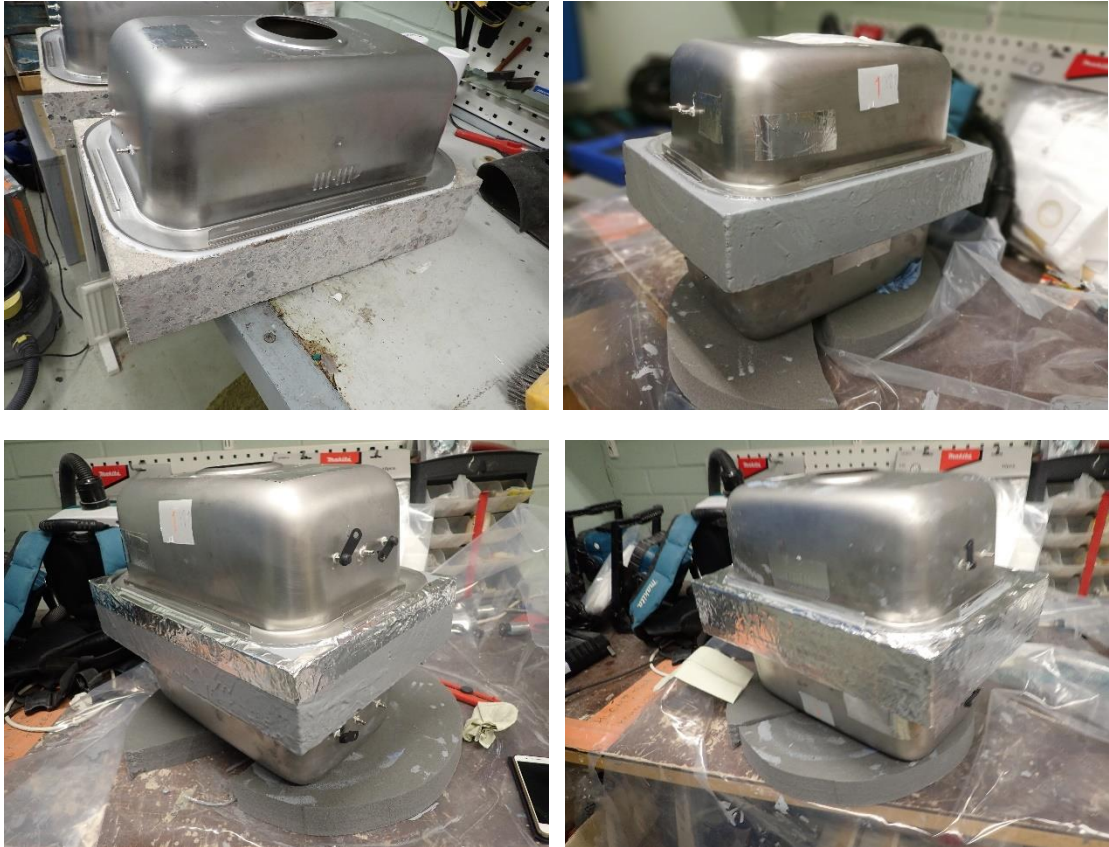
Kuva 7.6 Kammioiden kiinnitys koekappaleisiin vaiheittain. Kammio kiinnitetään ja tiivistetään ensimmäiseksi koekappaleeseen silikonilla. Molempien kammioiden kiinnittämisen jälkeen betonikappaleiden sivupinnat sekä ylä- ja alapinnat kammioiden reunaan asti tiivistetään TKR-pinnoitteella. Viimeiseksi kammioiden sivustat tiivistetään kaksinkertaisella alumiiniteipillä. Mittausyhteet tiivistettiin kammioihin silikonilla.
