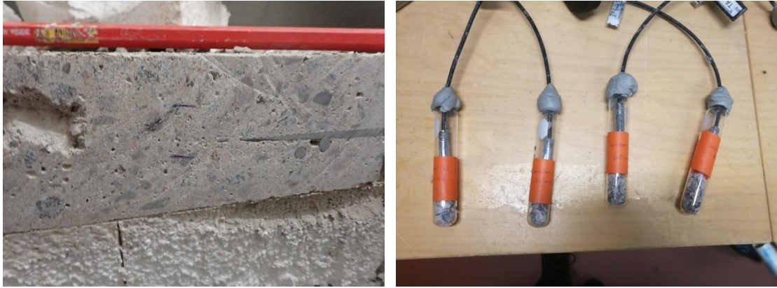
Kuva 7.4. Koekappaleen irrotuksen jälkeen betonilaatan leikkauspinnasta irrotettiin betonipaloja näytepalakosteusmittausta varten.
