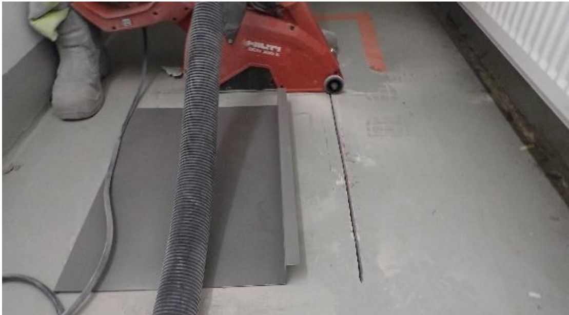
Kuva 7.3. Koekappaleen irrotus timanttisahaamalla.
