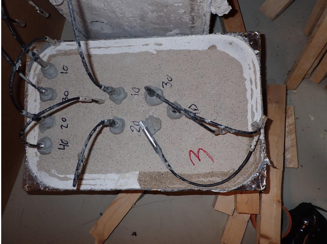
Kuva 7.8 Koekappaleiden kosteusjakauman mittaaminen radonläpäisevyyssmittausten jälkeen porareikämenetelmällä
