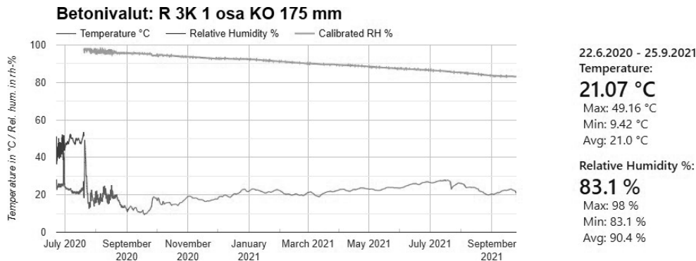
Kuva 4. MATolog CURE anturin tulokset n. vuoden ajalta betonivalusta. Valun päällystystöitä ei ole vielä aloitettu. Anturin asennussyvyys 175 mm pinnan tasosta. Kahteen suuntaa kuivuva holvirakenne. Pääjt-Hämeen keskussairaala 2021
