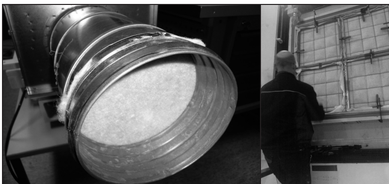
Kuva 3. Testeissä kuitunäytteet kerätään polypropeenikankaasta tehtyihin keräyssuodattimiin. Pienissä äänenvaimentimissa keräyssuodattimen koko vastaa yleensä äänenvaimentimen kanavaliitäntää. Suurilla äänenvaimentimilla keräyssuodatin rakennetaan 600 x 600 mm moduulikehyksiä yhdistämällä. Tällöin ilmavirrat voivat olla useita kuutioita sekunnissa.
