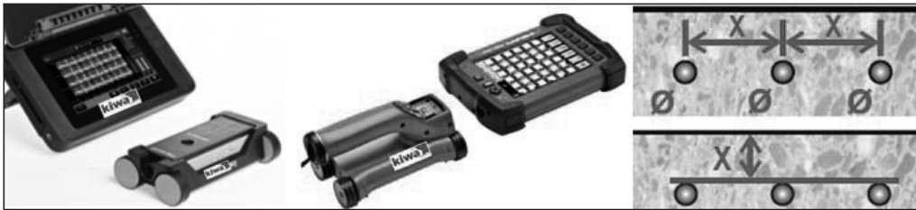
Kuva 4. Profometer PM-650A1 ja Hilti PS-250 tutkimuslaitteet.
