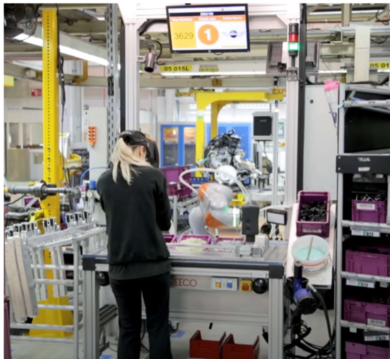
Kuva 5.3. KUKA yhteistyörobotti integroituna vetoniittien asennustehtävään (KUKA 2018).
