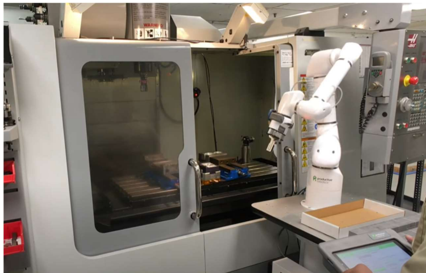
Kuva 5.1. Kuva OB7 yhteistyörobottijärjestelmästä CNC-työstökeskuksen vieressä (Five Nines - Plastics Division 2020).
