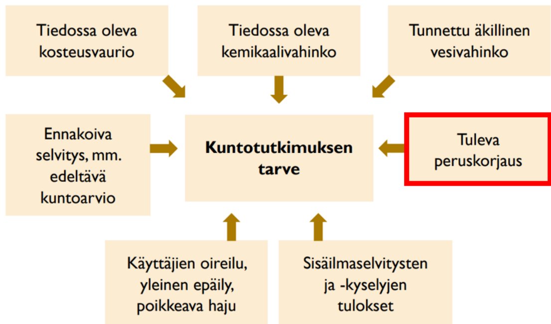
Kuva 1: Kuntotutkimuksen lähtökohdat. (Pitkäranta 2016, s. 25)
