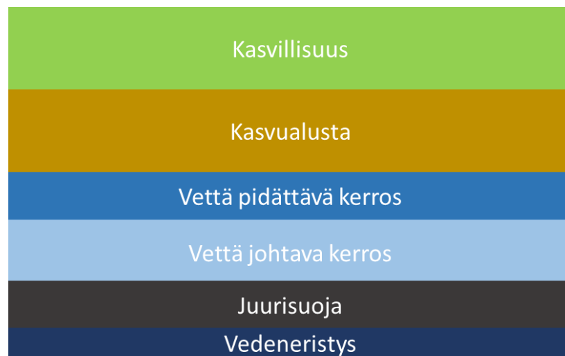
Kuva 1. Havainnekuva viherkaton yleisestä rakenteesta.
