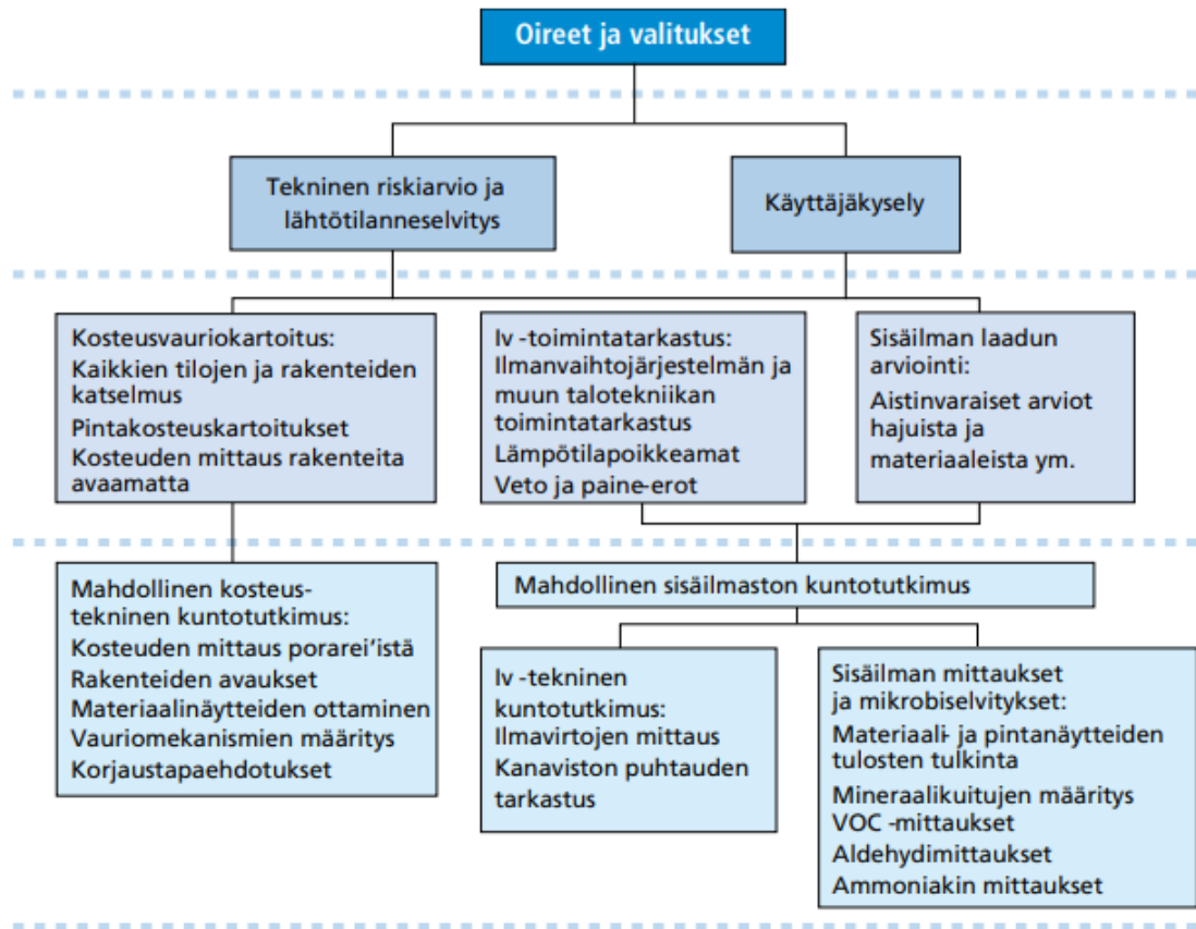
Kuva 8. Rakennuksen kunnon arvioinnin ja tutkimisen vaiheet. [3, s. 16].
