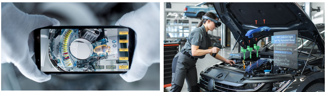
Kuva 2. Esimerkkejä lisätyn todellisuuden laitteista. Vas. Kädessä pidettävät (Kaminsky 2019) ja oik. AR-lasit (Kaminsky 2019).
