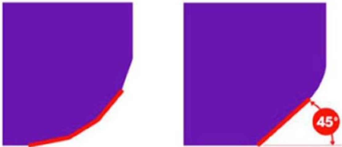
Kuva 8: Pyöristyksissä reuna levenee yli 45° kulmassa. (Elliot & Waters 2019, s. 57)
