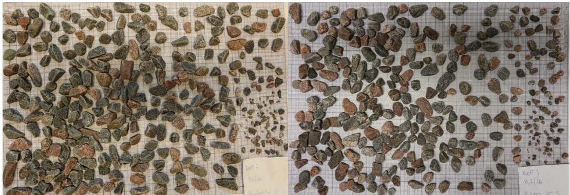
Kuva 71. Vasemmalla referenssikiviaineksen 1 normaali ja oikealla 600°C kuumennettu kuulamylynäyte testin jälkeen (lajite 11,2/16 mm).
