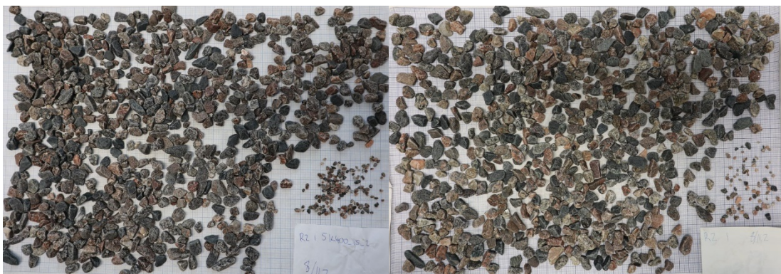
Kuva 67. Vasemmalla asfalttirouheen 2 sarjakuumennettu ja oikealla normaali kuulamylynäyte testauksen jälkeen (lajite 8/11,2 mm).
