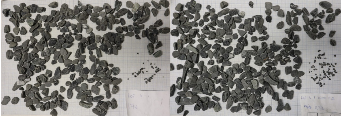
Kuva 70. Vasemmalla referenssikiven 4 normaali ja oikealla 600°C kuumennettu kuulamylynäyte testin jälkeen (lajite 11,2/16 mm).
