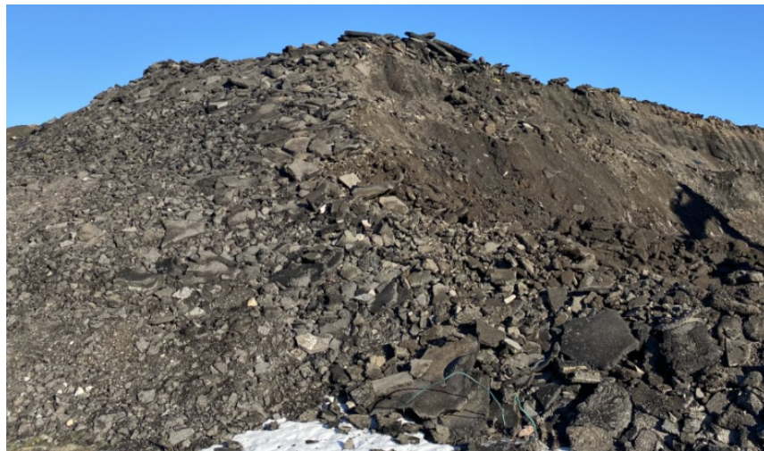
Kuva 7. Käytöstä poistettua asfalttipäällystettä.
