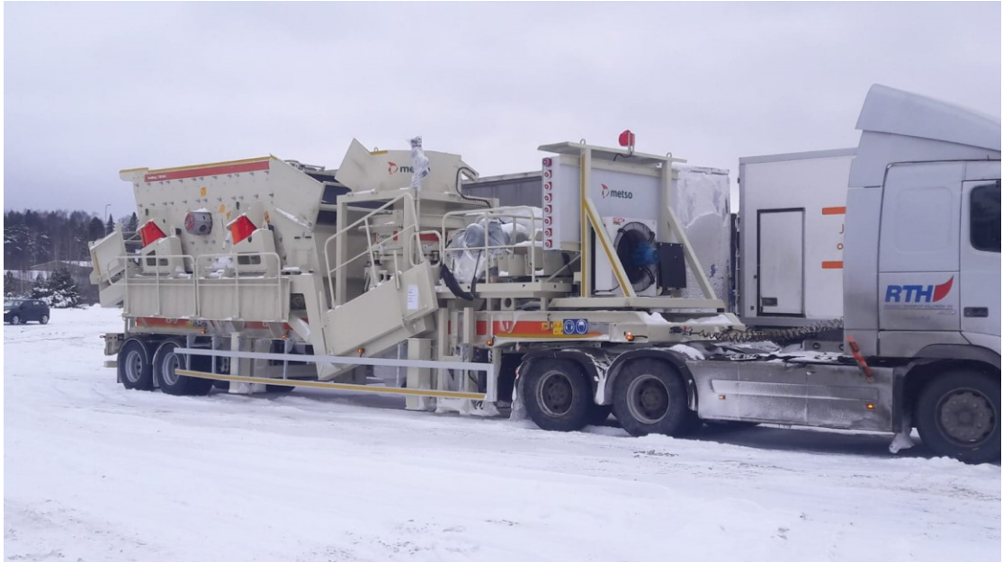
Kuva 1. Eräs Metso Outotecin pyöräalustainen murskain vetoautoineen (Metso Outotec 2019).
