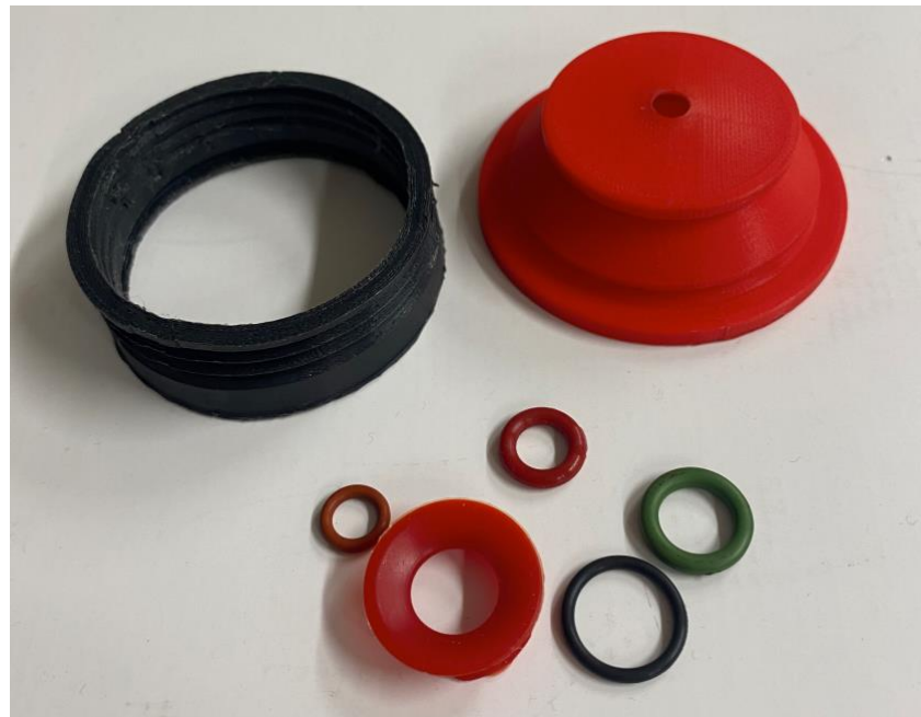
Kuva 11: 3D-tulostettu mittakärki ja tiivisterenkaita
