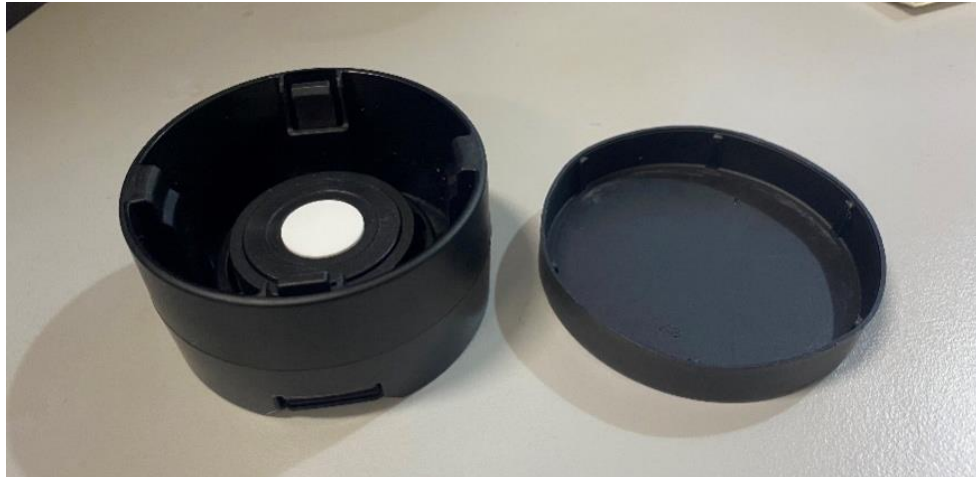
Kuva 24: Värisävymittarin kalibroitikärki (White calibration)
