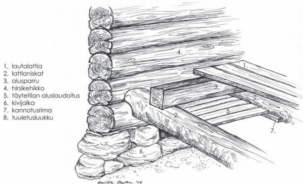
Kuva 10. Tuulettuva alapohja (Pohjois-Pohjanmaan korjausrakentamiskeskus 2005).
