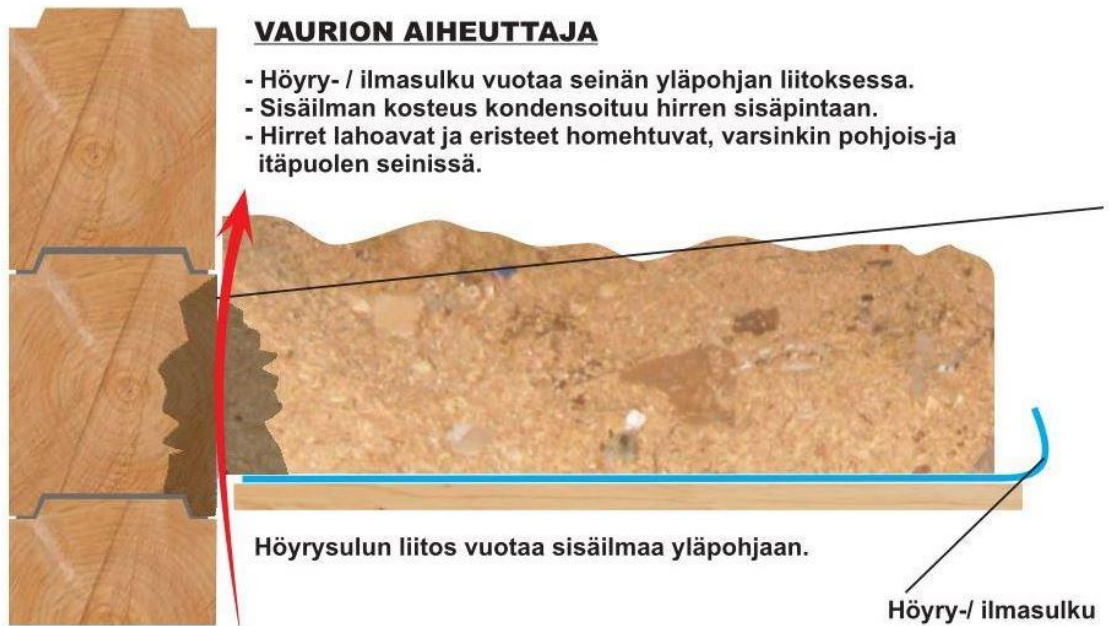
Kuva 24. Puutteellisen höyry- tai ilmansulun liitos rakenteeseen (Hometal- koot 2012).
