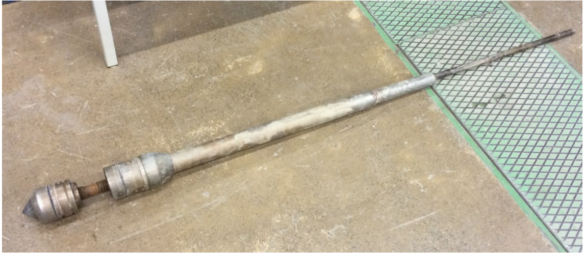
Kuva 43. 86 mm:n norjalaistyyppinen mäntäkaira. Mäntä on kuvassa kiertämistä vaille yläasennossa.
