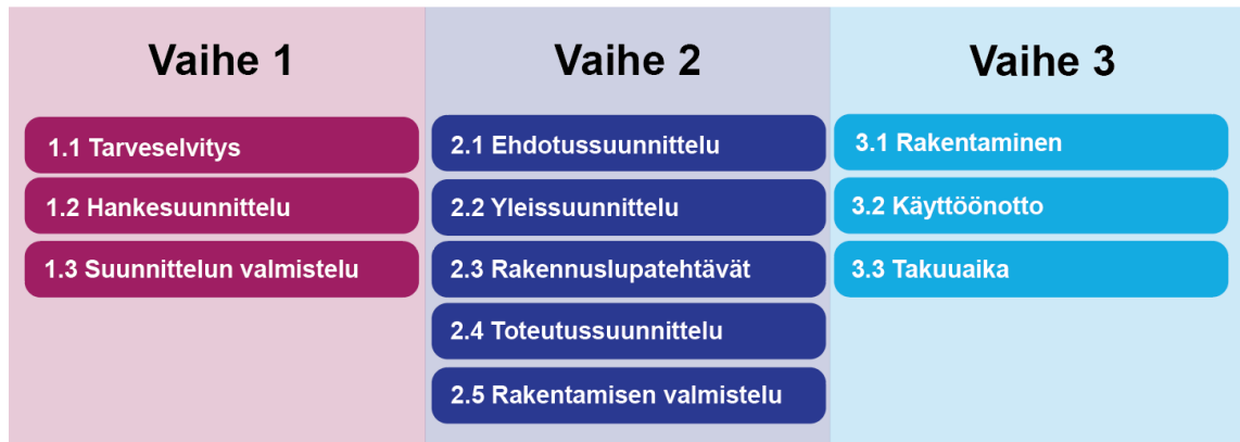
Kuva 4. Rakentamisen prosessi (mukailten Kallasjoki, 2016)
