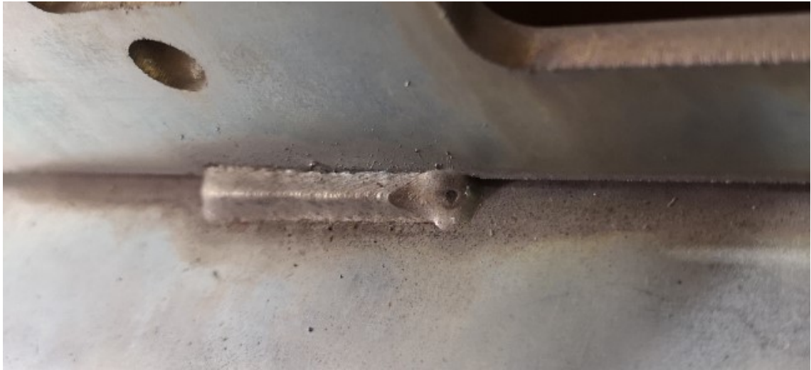
Kuva 27. Jännityskeskittymä pienahitsin alueella.
