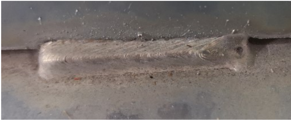
Kuva 33. Jännityskeskittymäalueen pienahitsi, jossa oletettu lovivaikutus.
