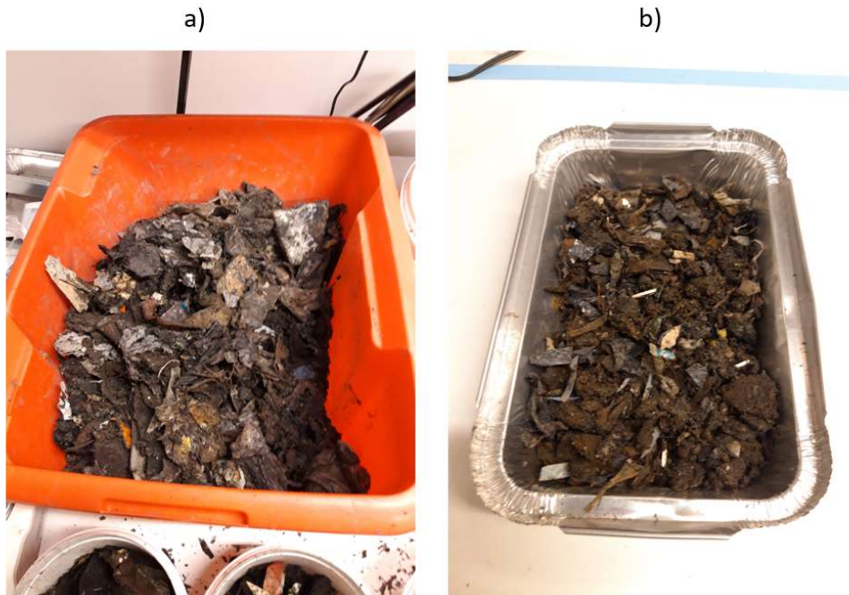
Kuva 7. Kaatopaikalta kaivettua jätemateriaalia (a). Reaktoreihin kasatun jätteen palakkoa pienennettiin manuaalisesti (b).
