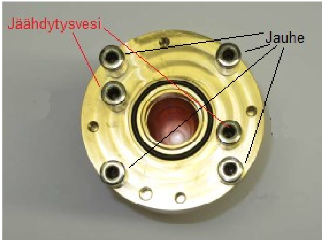
Kuva 34 Jauheen ja jäähdytysveden paikat suorakerrostuspäässä.
