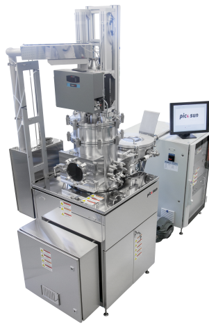
Kuva 4.1. ©Picosunin luvalla saatu kuva R-200 -reaktorista manuaalisella latauksella.
