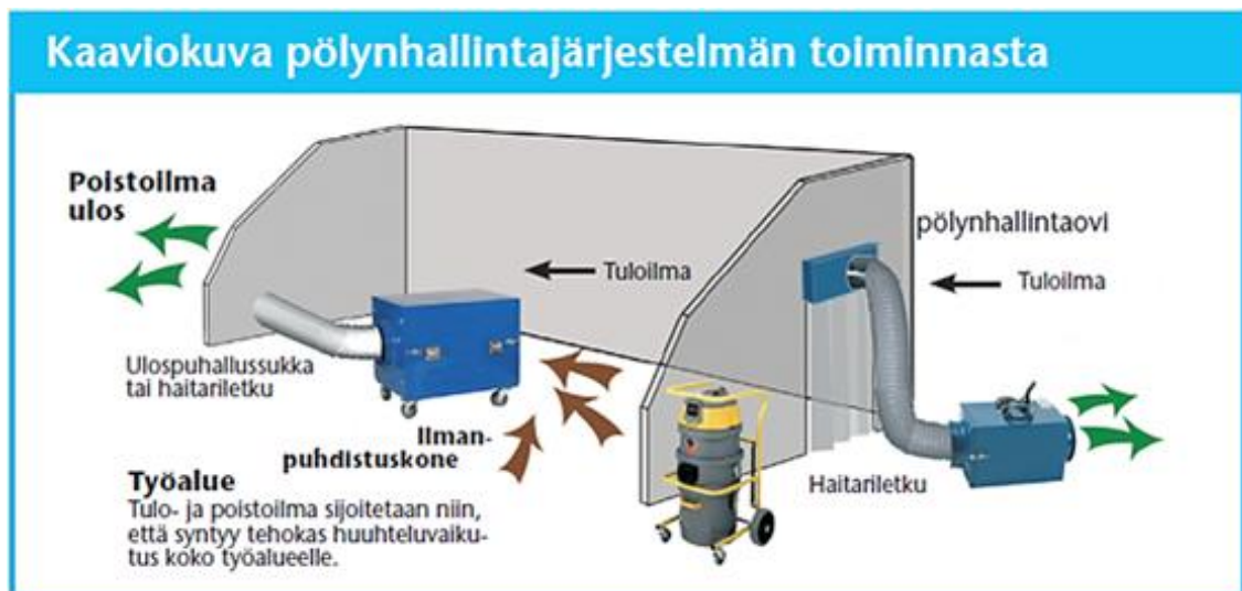
Kuva 1. Kaaviokuva pölynhallintajärjestelmän toiminnasta. (Koski et al. 2013)
