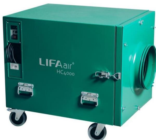
Kuva 3. LIFAairin HepaClean 4000 -alipaineistaja, jolle luvataan 3200m 3 /h ilmansiirto H13 Suodattimella. (LIFAair)
