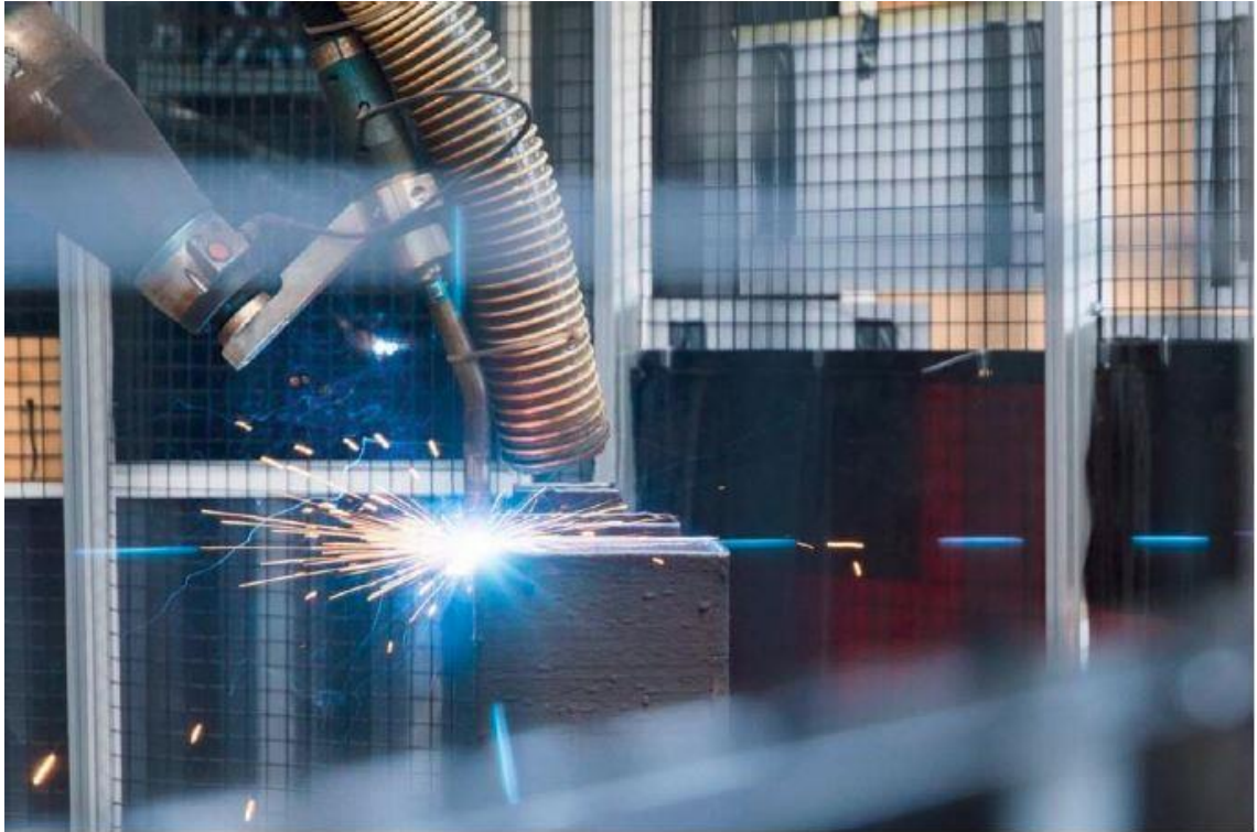
Kuva 4. Teräksisen poikkileikkauksen valmistusta robottikäsivarrella varustetulla WAAM-laitteistolla (Buchanan & Gardner 2019, s. 12).
