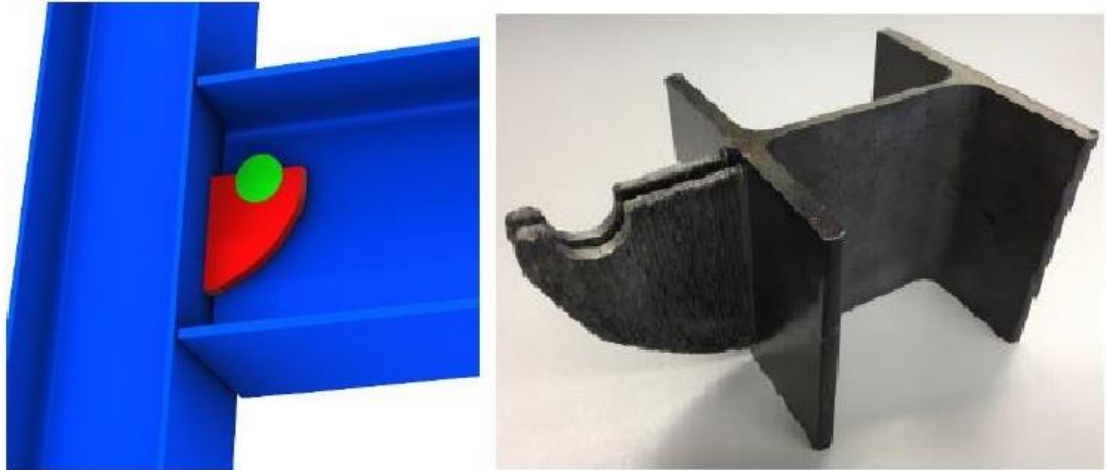
Kuva 16. Vasemmalla pilarin ja palkin liittämiseen kehitetty koukkuliitos animoitu ja oikealla I-profiilin laippaan WAAM-menetelmällä valmistettu koukkuosa (Feucht et al. 2019).
