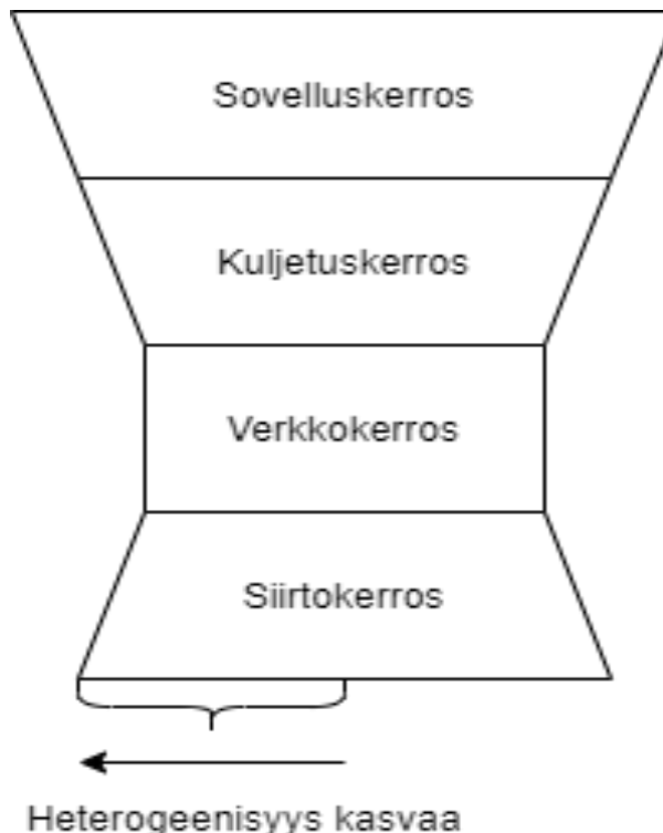
Kuva 3.3. Kuvaus IIoT-järjestelmien aiheuttamasta heterogeenisyydestä protokollapinos- sa [2]
