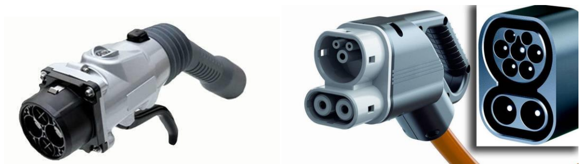
Kuva 18. Teholatauksessa käytettävät pistoketyypit CHAdeMO (vasen) ja CCS [41].
