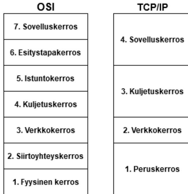
Kuva 4. OSI- ja TCP/IP-viitemallien kuvaajat vierekkäin. Kuten kuvasta huomataan TCP/IP-viitemallin kerrokset vastaavat yleensä useita OSI-viitemallin kerroksia. [11, s. 9]
