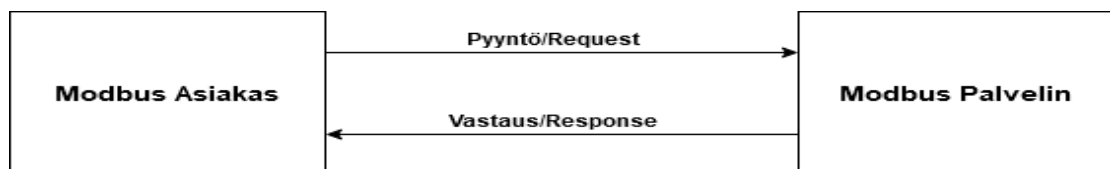
Kuva 10. Modbus asiakas-palvelin-mallin muodostama pyyntö/vastaus viestiyhteys pari. [22, s. 2]
