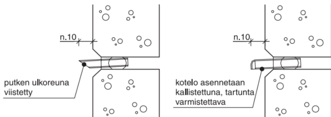
Kuva 9. Tuuletusputkien ja -koteloiden asennus (RT 82-10766 2002, s. 10)
