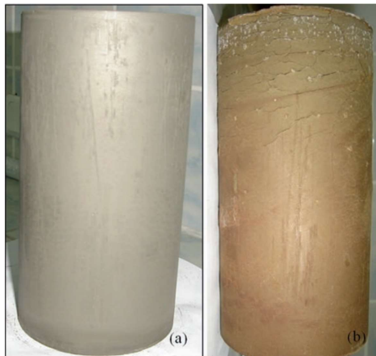
Kuva 4 Kovettuneen CPB näytteen ulkonäkö a) 28 päivän ja b) 360 päivän jälkeen. Halkeamien muodostuminen johtuen pitkäaikaisista happo- ja sulfaattihiökkäyksistä. [5]
